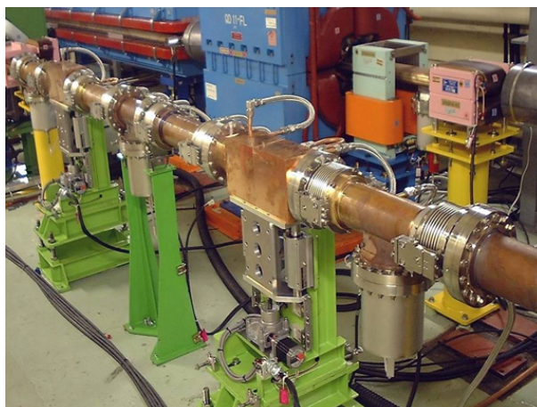
図 4: KEKB 可動ビームマスク (中央下部がステッピング・モーター)
