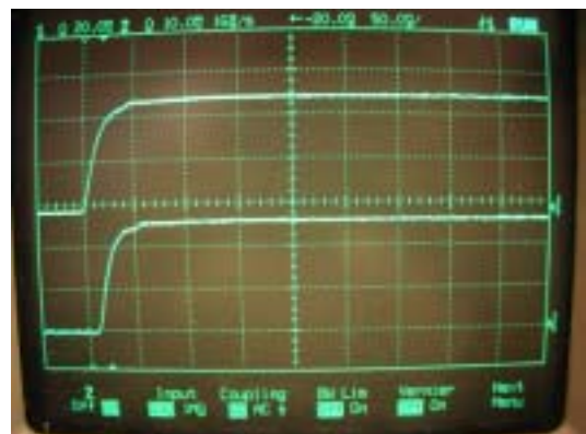
図2：上)SバンドRFパルスと下)CバンドRFパルスの立ち上がりの比較。横軸は50ns/div.
