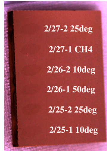
写真2 SR照射テスト後のミラー
