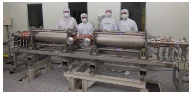
図 5: クリーンルーム内での空洞接続完了。
