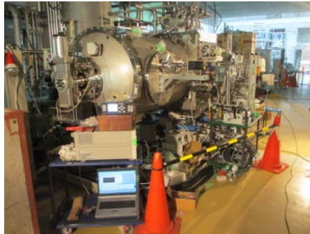
図 6: cERL に設置された主加速部 cryomodule
