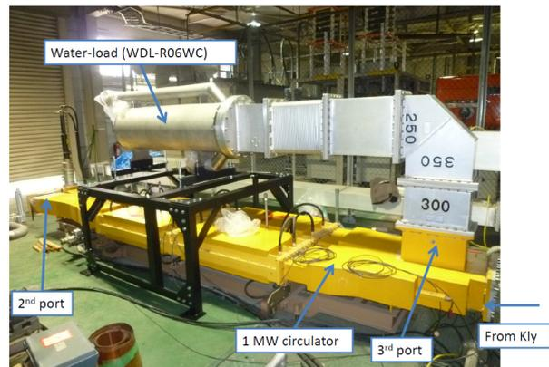
図 1: 円形導波管型ウォーターロードの外観
