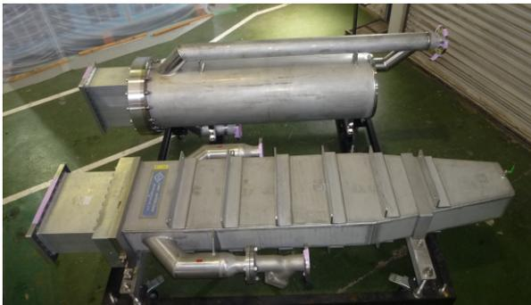
図 2 : 円形導波管型 (上)、矩形導波管型 (下)
