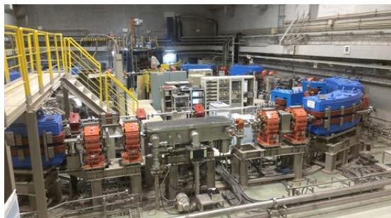
Figure 5: 1.3GeV Electron Synchrotron.
