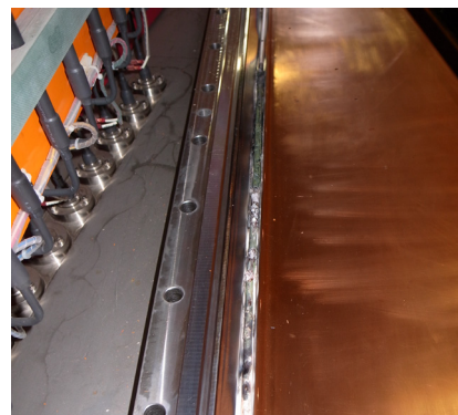
Figure 4: Burned-out C-ring in fRC-W resonator. 焦げた原因は接合面の締め付けが不十分であると考
