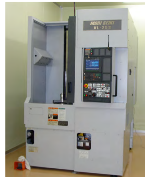
CNC縦旋盤(森精機製)
