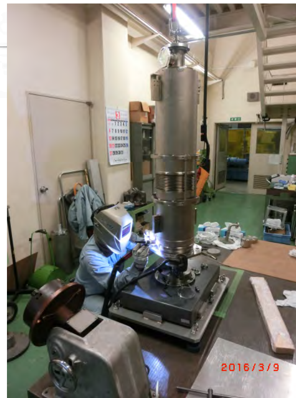
ジャケットと空洞のTIG溶接
