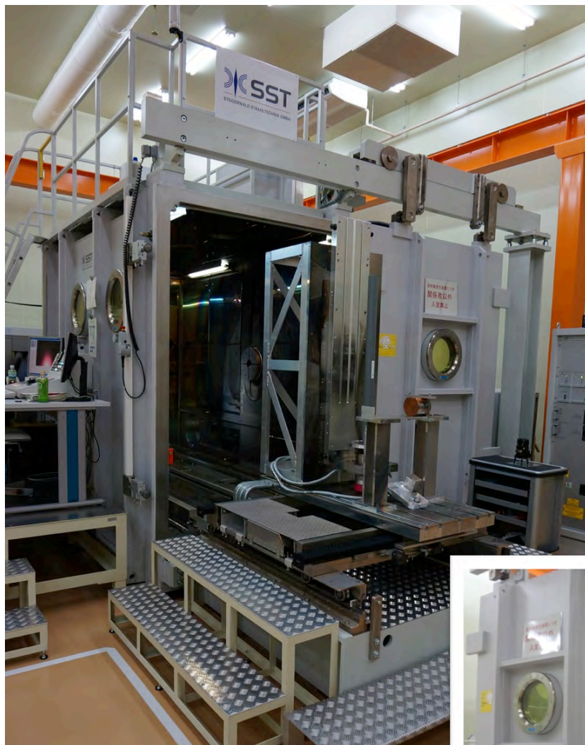
KEKで使用している電子ビーム溶接機(ドイツ SST社製)
