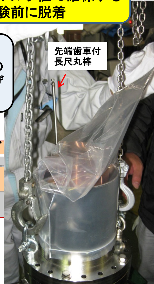
ループ結合部の取外し作業
