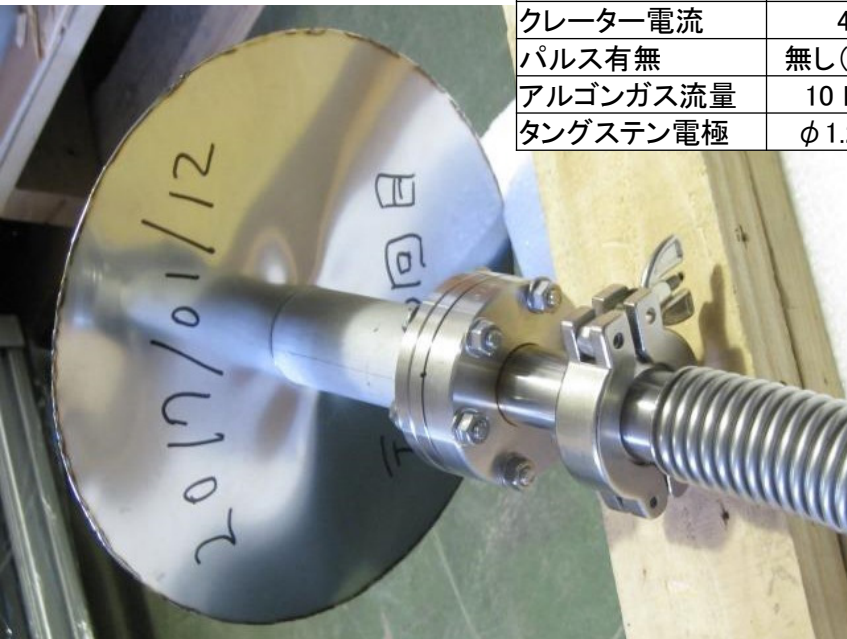
真空試験中の溶接模擬試験用供試体
