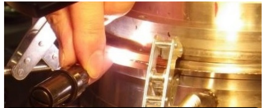
リップ部の溶接個所の冷やし金の固定
