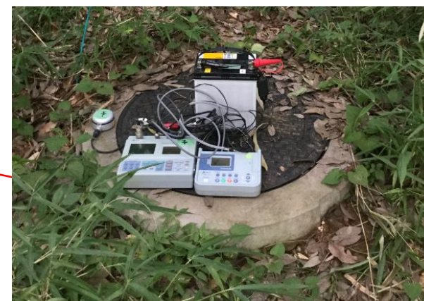
使用機器: VM-53(公害振動計) 測定内容: XYZ加速度測定
