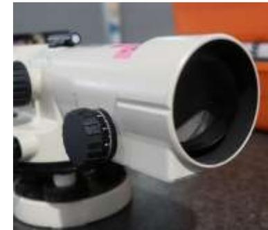
最短合焦距離0cmと近くが測定できる。(AS-2では90cm、NA2では1.6m)
