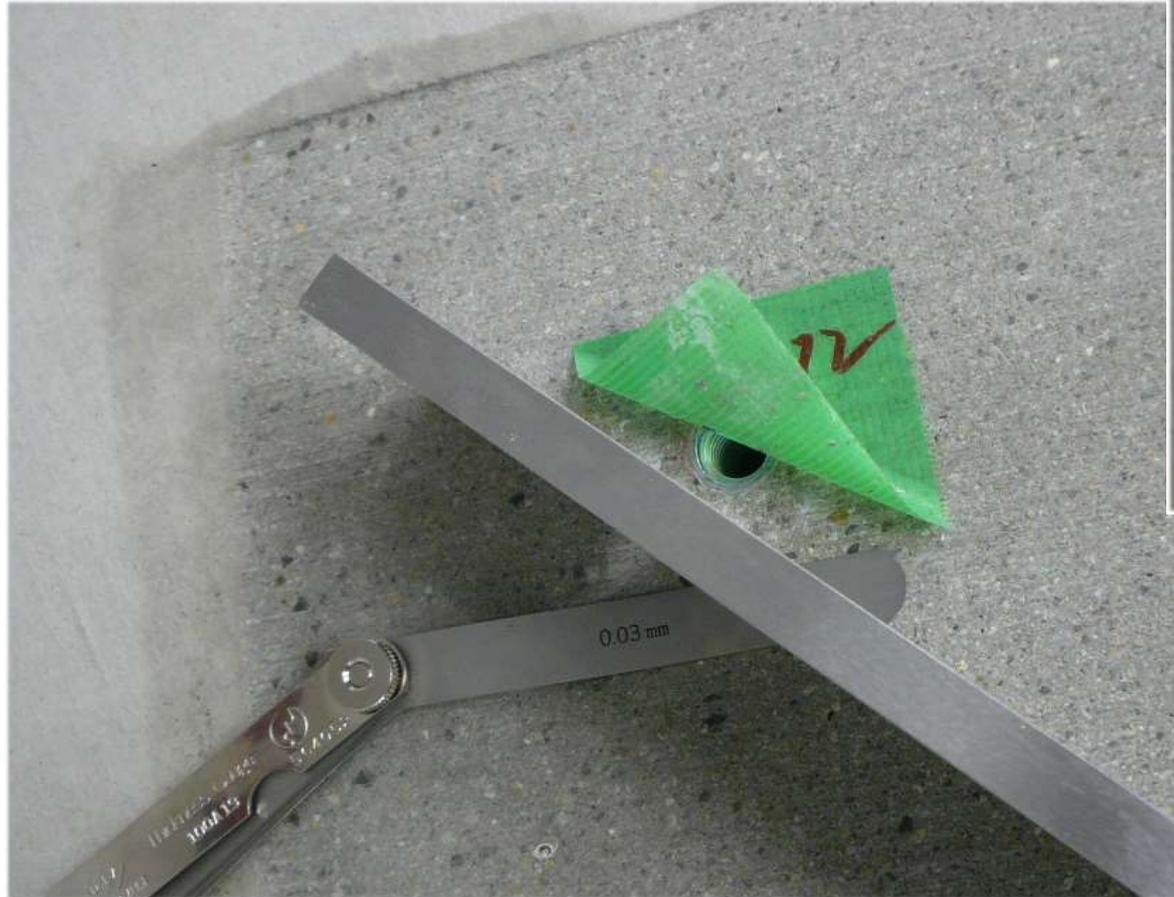
「超荒仕上げ」の場合 筋が見える
