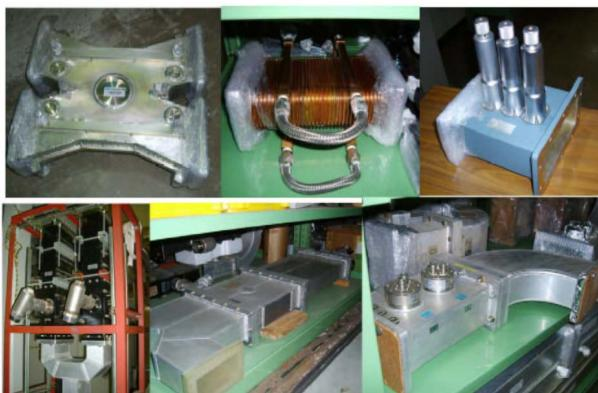
図2 移管導波管の例。右上より3dBハイブリッド、フレキシブル導波管、3スタブチューナー、可変短絡板、方向性結合器とHバンド。
