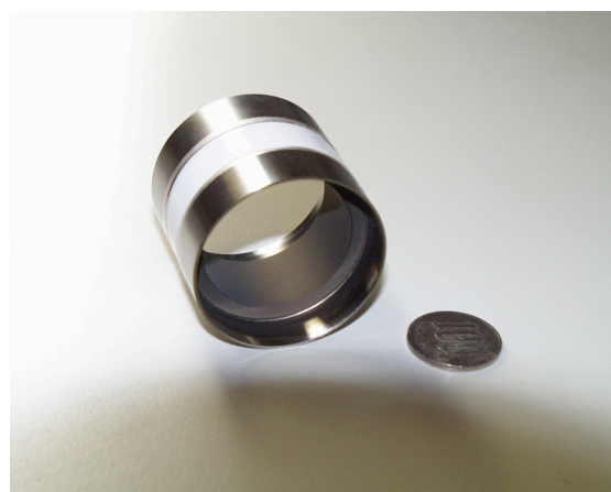
図5. 内面にTiN成膜を処理したセラミックダクト。
