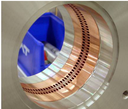
図4：櫛歯RFブリッジを適応した円形断面ゲートバルブの内面(開状態)。
