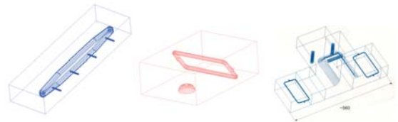
図5：左より移相器、リフレクター、及びマジックティーとレフレクター組合せによる移相器
