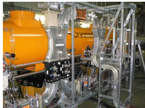
図6：クライオモジュールに組み込まれたPDS
