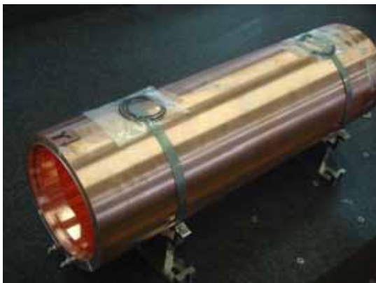
図2 3分割された108MHzSHB空洞。(上)内導体と上流側端盤、(中)上流側端盤、(下)外導体。
