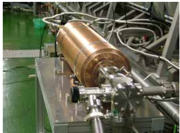
図3 108MHzSHB空洞2号機のハイパワー試験。
