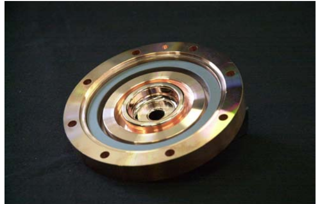
図3：SiCを圧入したCバンド加速管セル
