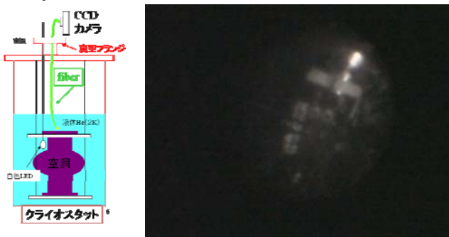
図10：クライオスタット内可視化システム概念図(左)。ファイバーによる2K条件下での空洞上部の観測。空洞のインポートポートが見える(右)。
