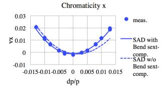
図5:水平方向クロマティシティの測定値(●)と SADによる計算値、偏向電磁石磁場の六極成分を考慮したもの(実線)と考慮しないもの(点線)。
