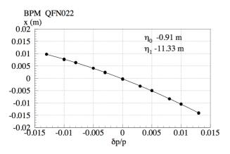
図2:BPM022 での水平方向ビーム位置についての 運動量偏差依存性。
