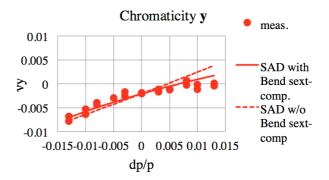
図6:垂直方向クロマティシティの測定値(●)と SADによる計算値、偏向電磁石磁場の六極成分を考慮したもの(実線)と考慮しないもの(点線)。
