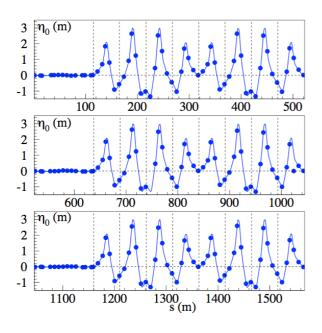
図3:線形ディスパージョンの測定値(●)と SAD による計算値(実線)。MR 全周のうち、上図に直線部 A とアーク部 A、中図に直線部 B とアーク部 B、下図に直線部 C とアーク部 C を示す。
