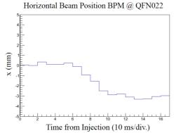
図1:BPM022 での水平方向軌道位置の時間的な変化。入射後0.05 s から0.1 s の間で運動量偏差0.5 %に対応する rf 周波数を変化させている。
