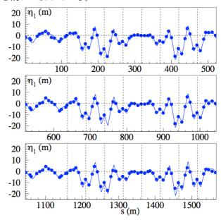
図4: 非線形 1 次ディスパージョンの測定値(●) と SAD による計算値(実線)。 MR 全周のうち、 上図に直線部 A とアーク部 A、中図に直線部 B と アーク部 B、下図に直線部 C とアーク部 C を示す。
