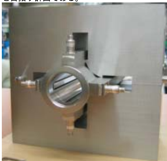
図3 SDTL用BPM模擬四極電磁石据付状態
