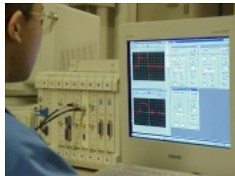
図 2: WE7000 で波形を取り込み中
